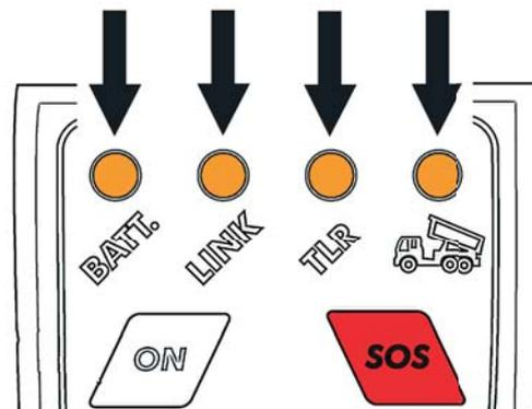
Nel cablaggio elettrico è previsto anche un sistema d'emergenza per azionare la centralina in condizione di trasmettitore scarico o guasto.
